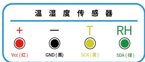
Vcc:电源(红色); GND (黑色); SCK(黄色或者白色); SDA(绿色或者蓝色)
